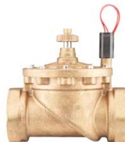
ZAWÓR IBV-301G-FS Średnica wlotu: 3" (80 mm) Wysokość: 23 cm Długość: 22 cm Szerokość: 18 cm
